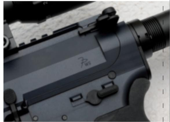
Vista del lato sinistro del fusto. Si noti la manetta di armamento in stile AR 15 e il selettore di tiro a due posizioni
